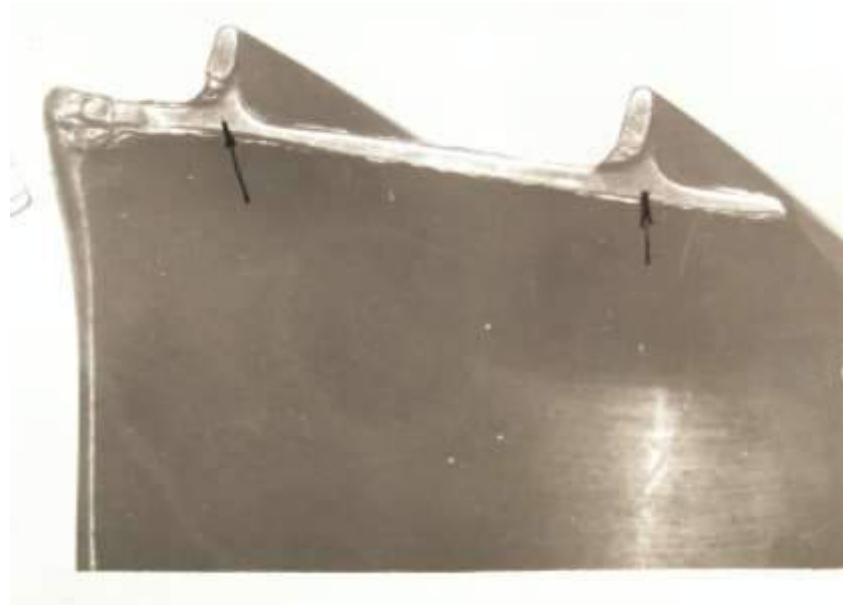
Рисунок 1.3 – Знос лопатки турбіни після працювання 2458 годин.
