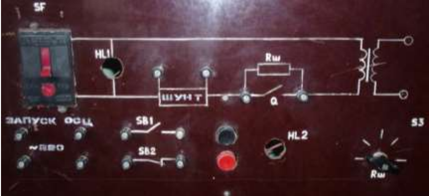
Рисунок 3.1 – Зовнішній вигляд лицевої панелі лабораторної установки.
