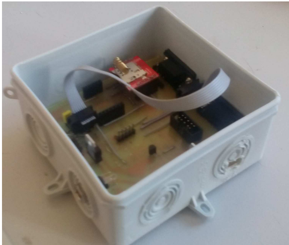
Рисунок 2.17 – Зовнішній вигляд плати керування з модулем передачі даних вмонтованих в корпус (Фото2)
