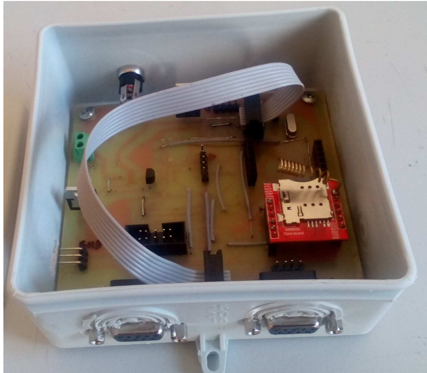
Рисунок 2.16 – Зовнішній вигляд плати керування з модулем передачі даних вмонтованих в корпус (Фото1)
