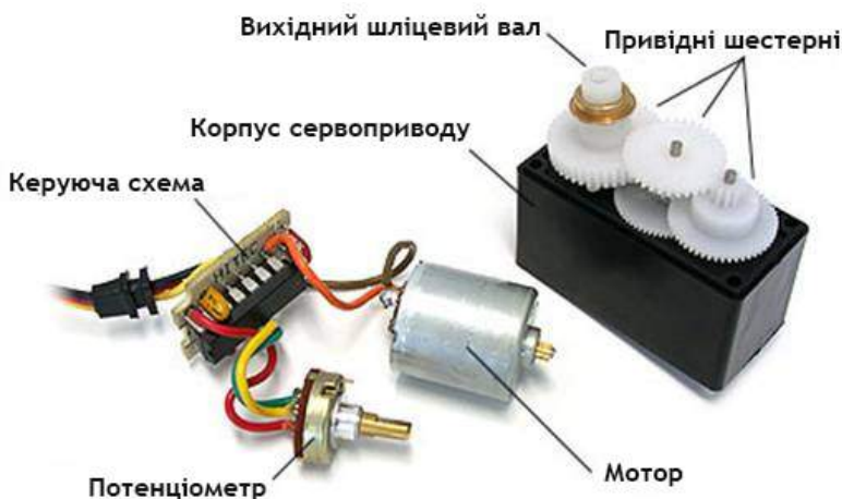
Рисунок 14.2 – Конструкція сервоприводу
