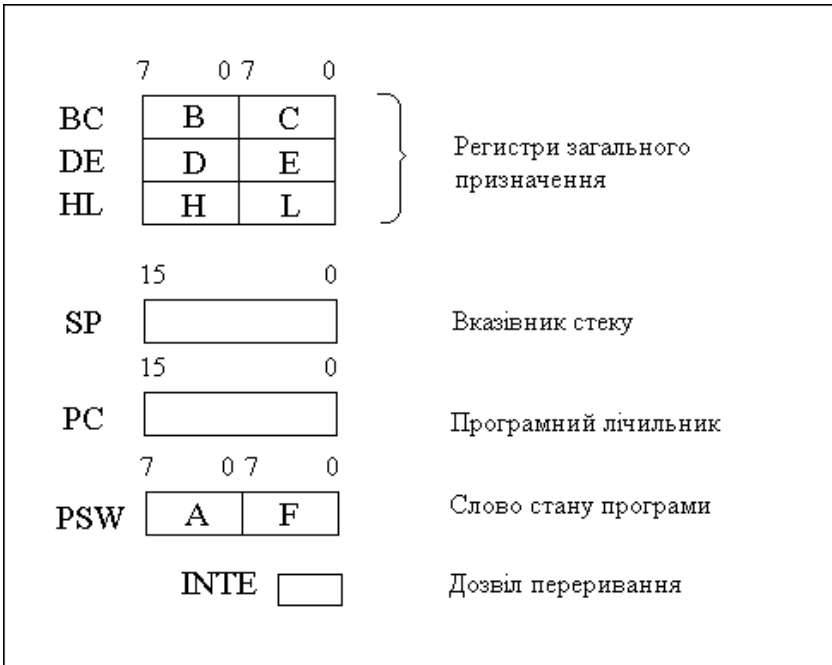
Рисунок 2.5 - Блок реєстрів мікропроцесора
