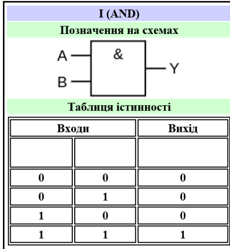
Рисунок 1.1 – Логічний елемент І
