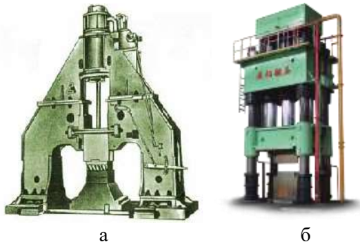
а – пароповітряний молот; б – гідравлічний кувальний прес Рисунок 2.2 – Потужне обладнання для кування
