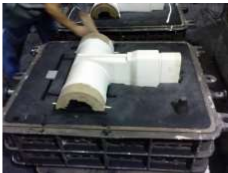
Рисунок 1.6 - Нижня півформа в опоці з вкладеним стрижнем
