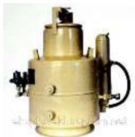
Рисунок 3.7 – Ацетиленовий генератор типу ВВ з водяним затвором праворуч
