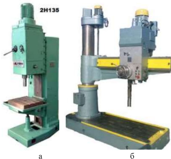
а – вертикально-свердильний; б – радіально-свердильний Рисунок 4.6 – Види свердильних верстатів
