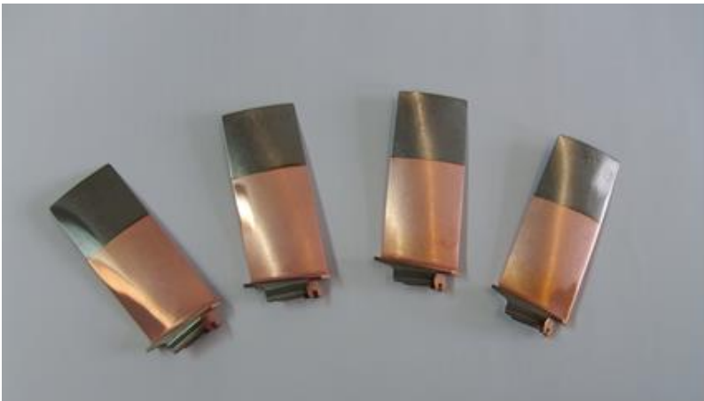
Рисунок 3.2 - Лопатки з покриттям наноструктурною міддю
