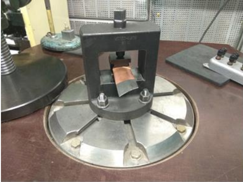
Рисунок 4.1 - Лопатка з покриттям із міді, закріплена на стенді ВЕДС-400
