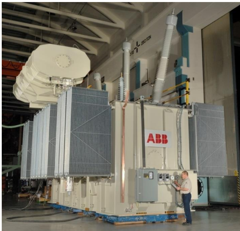
Рисунок 1.1 – Шунтувальний реактор на 420 кВ виробництва фірми АВВ
