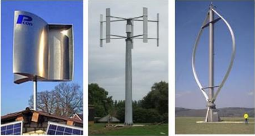
а) з ротором Савоніуса; б) з ротором Масгрува; в) з ротором Дар'є; Рисунок. 3.3. - ВЕУ з вертикальною віссю обертання
