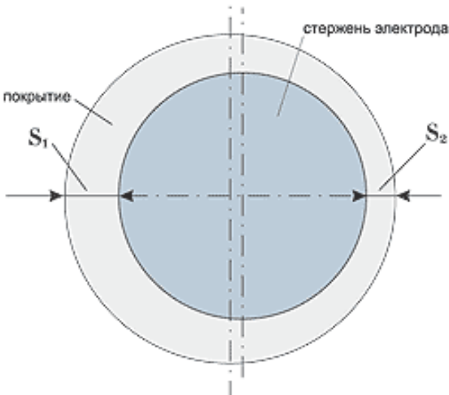
Рисунок 2.3 - Схема різнотовщинності покриття
