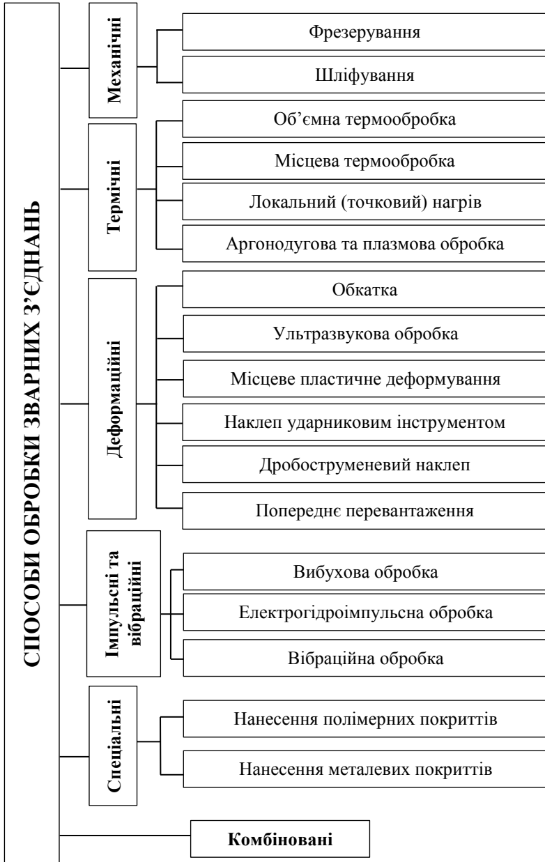
Рисунок 1.1 – Класифікація способів обробки зварних з'єднань
