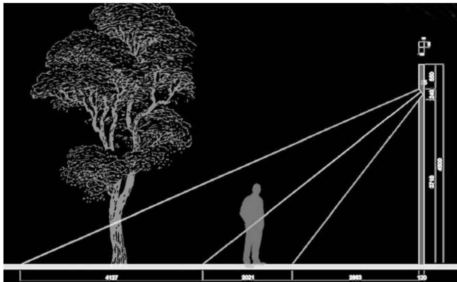
Рисунок 1.3 – Паркова металева опора висотою 4 м
