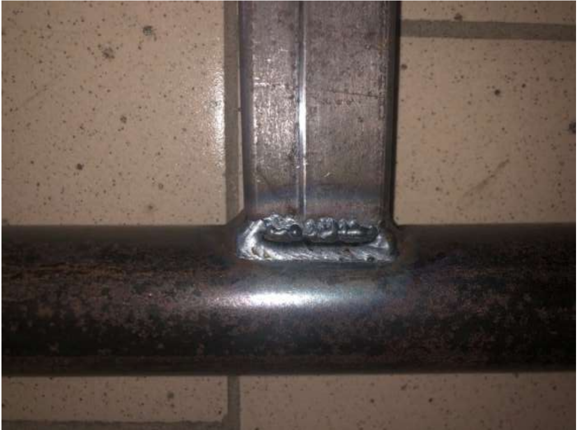
Рисунок 3.4 – Фото шва при початковому режимі I
