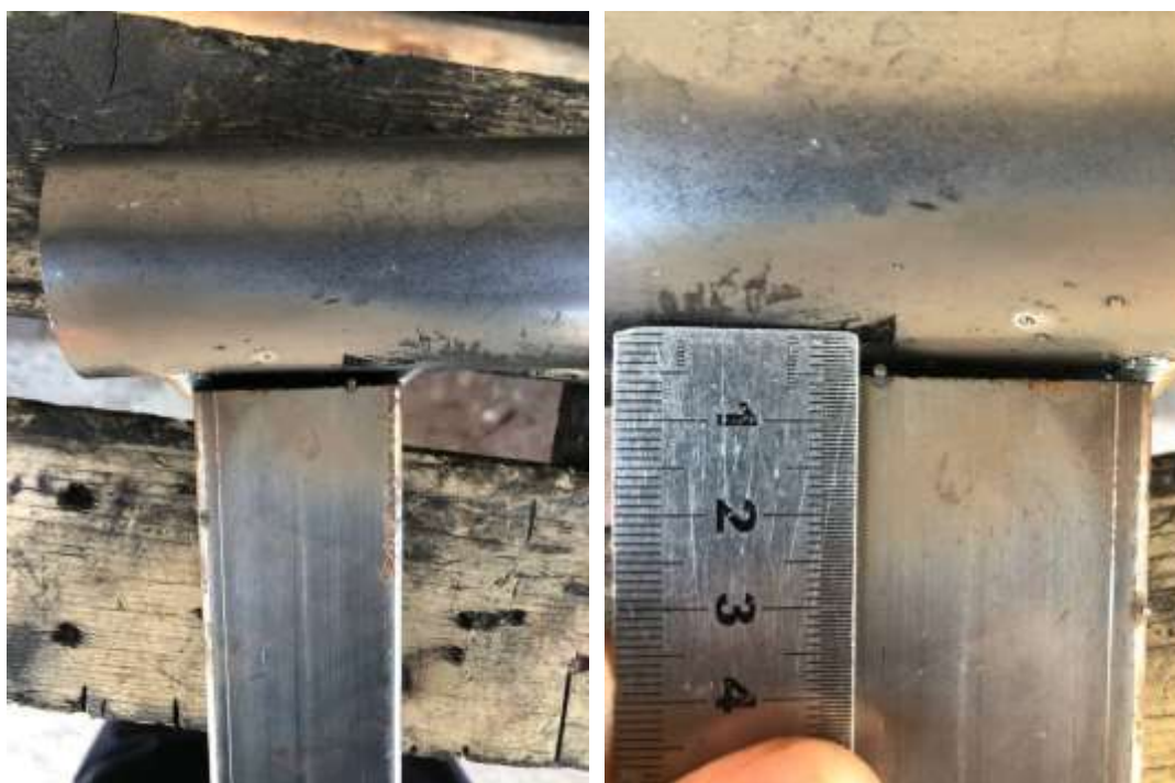
Рисунок 3.3 – Фото зазору на тестових деталях
