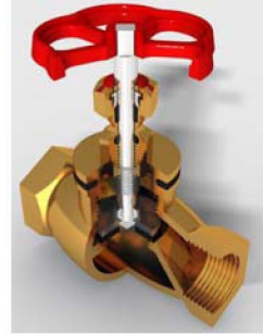
Рисунок 1 – 3D-модель клапану, створена в системі AutoCAD
