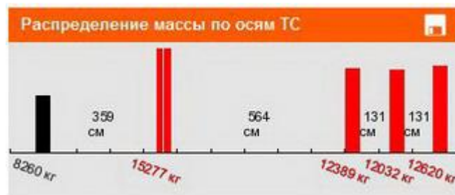
Рисунок 4.4 – Приклад навантажень на вісі вантажівки з вказаними відстанями між осями.
