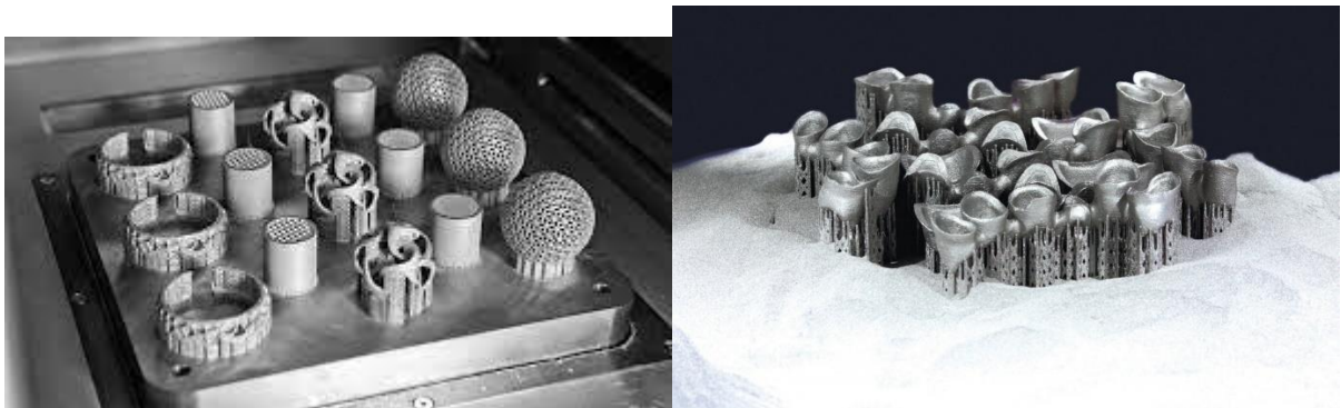
Рис. 29 - Селективное лазерное спекание (SLS) металлического порошку
