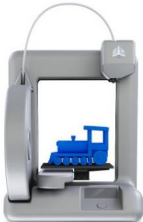
Рис. 36 – Первый компактный принтер 3D Cube от компании 3D Systems
