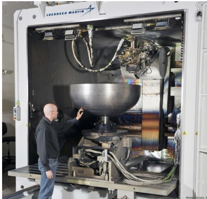
Рис. 38 - Металевий 3D-принтер Sciaky EBAM 300 System
