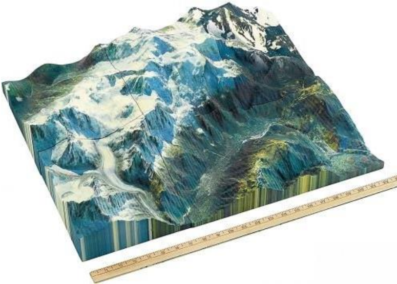
Рис. 9 – Модель, виготовлена методом пошарового формування з листового матеріалу
