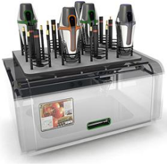
Рис. 35 – Принтер Cornucopia для друку продуктів харчування
