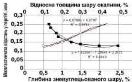
Рисунок 15 – Взаємозв'язок міжпластинчатої відстані у перліті від глибини знеуглецьованого шару (-○-) та відносної товщини шару окалини (-■-) високовуглецевої катанки, підданій ТМО.
