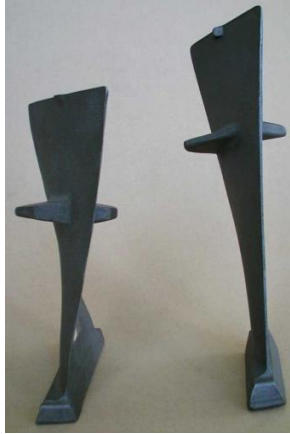
Рисунок 6.6– Лопатки дисків компресора ГТД
