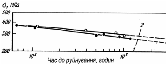
Рисунок 1.13 – Довготривала міцність при 800 \text{ }^\circ\text{C} нікелевого сплаву, зміщеного фазою \text{Ni}_3(\text{Al}, \text{Ti}, \text{Nb}) , після ВДП (1) і ЕПП (2)
