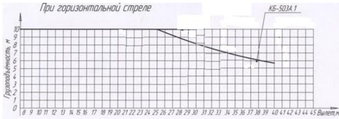
Рисунок 3.1 – Характеристики баштового крану при вильоті стріли
