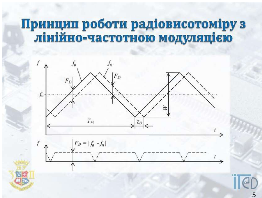
Рисунок Г.5 – Принцип роботи радіовисотоміру з лінійно-частотною модуляцією
