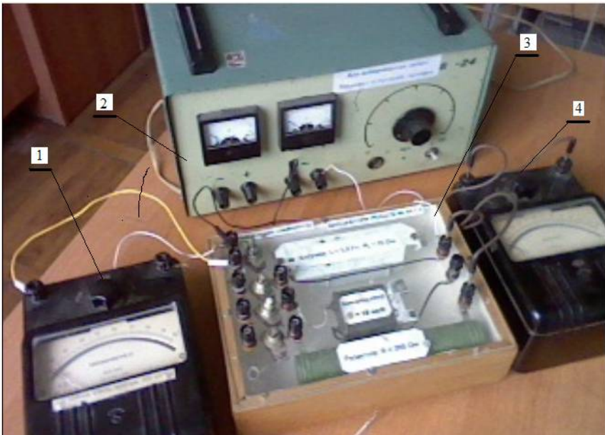
Рисунок 14.1. Загальний вид лабораторної установки: 1 – міліампер метр, 2 – джерело живлення змінного струму, 3 – лабораторний стенд, 4 – вольтметр.
