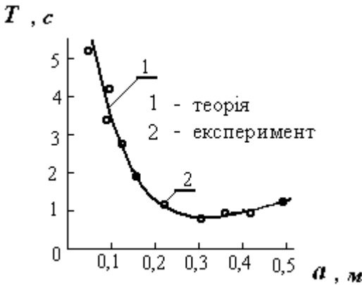
Рисунок 12.2. Рисунок 2 Теоретичний та експериментальний графіки T = f\left(\frac{a}{l}\right)
