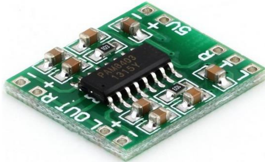
Рисунок 2.5 – Обраний підсилювач частоти аудіодіапазону
