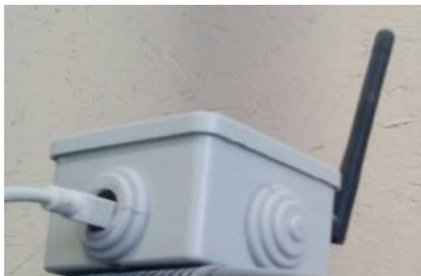
Рисунок 3.8 – Фото зібраної конструкції приймача сигналу
