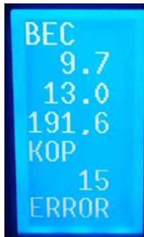
Рисунок 5.18 – Напис на виносному дублюючому табло в разі установки ящика з неправильним вагою
