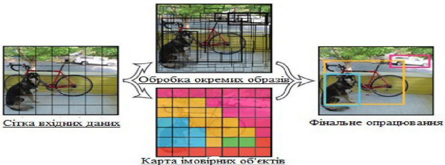
Рисунок 1 – Алгоритм роботи YOLO
