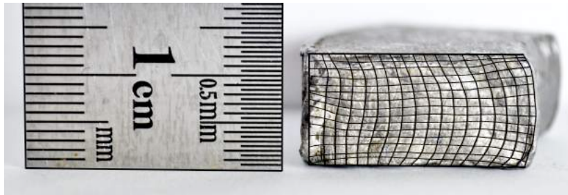
Рисунок 10 - Осаджування з повним обмеженням течії металу по зовнішній бічній поверхні.
