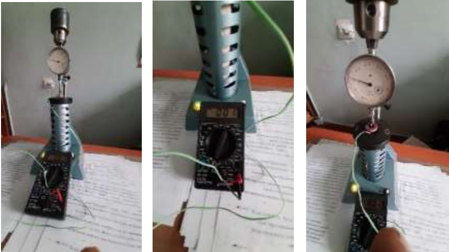
Рисунок 2.15 – Пристрій для демонстрації лінійного розширення твердих тіл
