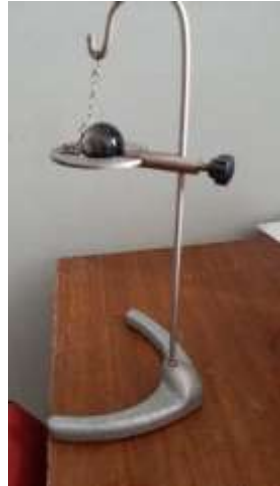
Рисунок 2.16 – Пристрій для демонстрації розширення твердих тіл
