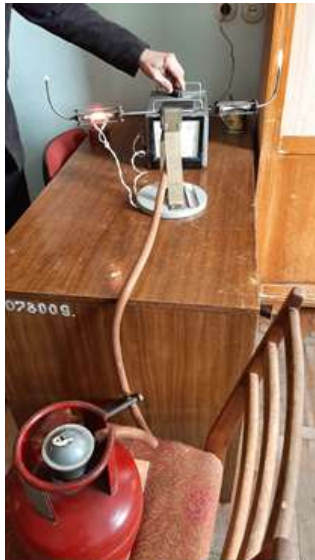
Рисунок 1.5 – Демонстраційний пристрій температурної залежності в'язкості газу.
