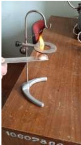
Рисунок 2.16 – Пристрій для демонстрації розширення твердих тіл
