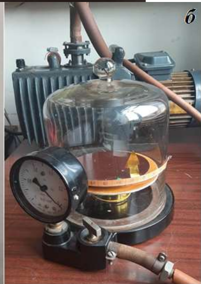
Рисунок 1.3 – Диск на нитяному підвісі (а) та в умовах пониженого тиску (б)
