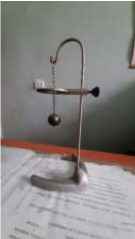
Рисунок 2.16 – Пристрій для демонстрації розширення твердих тіл
