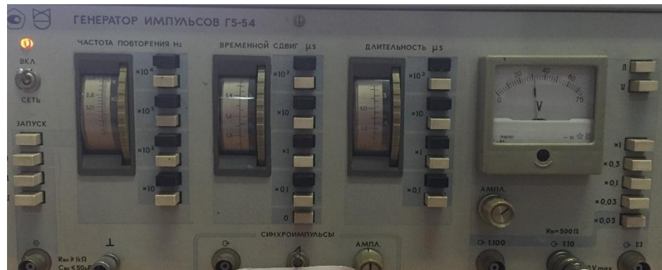
Рисунок 3.14 – Встановлені параметри сигналу на генераторі імпульсів Г5-54
