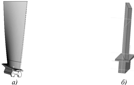
Рисунок 2.1 – Лопатка компресора двигуна ТВ3-117: твердотільна повнорозмірна модель (а) та її спрощена модель (б)
