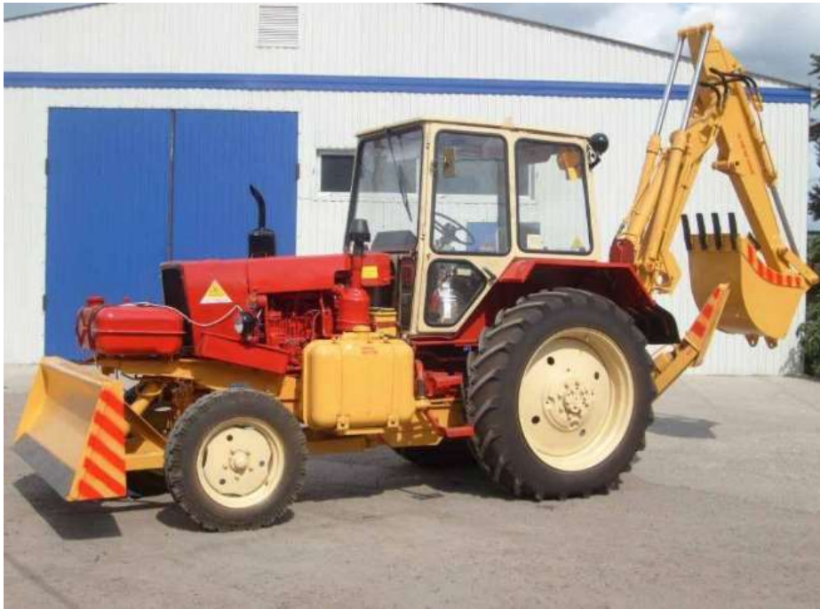
Рисунок 3.1 – Наведений екскаватор ЕО-3323
