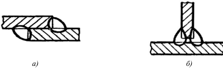
Рисунок 1 – Напускове (а) і таврове (б) зварні з'єднання
