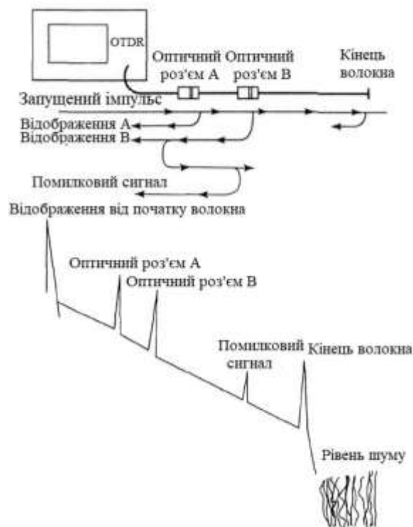
Рисунок 3.21 - Типовий пік від помилкового сигналу
