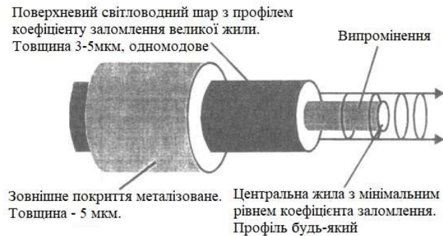
Рисунок 3.6 - Оптичне волокно з поверхневою металізацією
