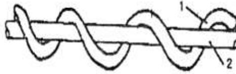
Рисунок 3.12 – Навивка ОК на грозотрос:
