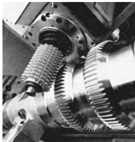
Рис. 4.28. Установка черв'ячної фрези в револьверній голівці токарного багатоцільового верстата Millturn фірми WFL Technologies GmbH & Co.KG
