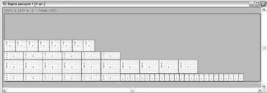
Рисунок 3.4 – Оптимальний розкрий листового матеріалу, отриманий за допомогою програми «АСТРА-Д»
