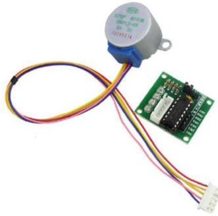
Рисунок 2.2 – Кроковий двигун 28BYJ-48 з мікросхемою ULN2003 і платою драйвера (зображення з джерела [13])
