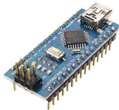
Рисунок 2.1 – Плата мікроконтролера Nano V3.0 ATmega328 16M 5V CH340G (зображення з джерела [12])
