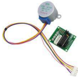
Кроковий двигун 28BYJ- 48 з мікросхемою ULN2003 і платою драйвера
