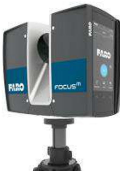
Рисунок 1.6 – Сканер FARO Focus Premium польоту (зображення з джерела [9])
