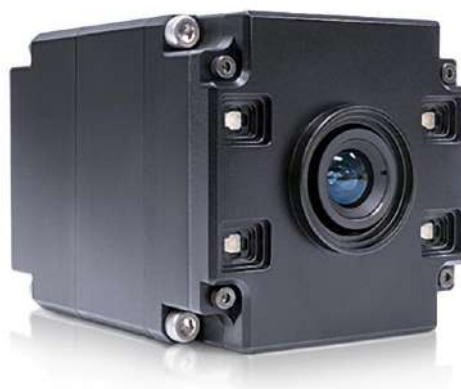
Рисунок 1.4 – Helios ToF 3D camera features Sony's DepthSense IMX556PLR backside-illuminated (BSI) sensor. (зображення з джерела [8])
